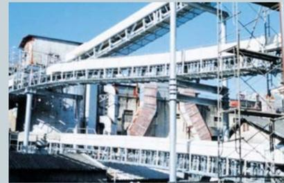
中間原料搬送に活躍するスーパーコンベヤ。原料タンクが林立する環境でも、カーブ輸送や傾斜輸送が自在で、省スペースが図れるスーパーコンベヤの特徴が遺憾なく発揮されています。原料タンクから上り2基、下り1基の搬送ラインがカーブを描いて設置され、搬送物への異物混入や飛散などのリスクを防止しています。
