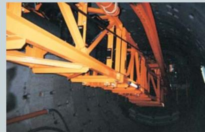
シールド工法の掘削現場で土砂の搬送ラインとして活躍するスーパーコンベヤ。掘削が進むにつれて現場がカーブを描くようになると、スーパーコンベヤならば、カーブに添った搬送ラインを容易に設置することができます。シールドマシンにどこまでも付いていくのが、「超円筒形コンベヤ」スーパーコンベヤです。
