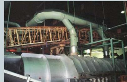
鋳物砂の搬送に活躍するスーパーコンベヤ。粉塵防止のために設置されましたが、限られた建設空間の有効利用にも効果を発揮しています。傾斜ラインから水平ラインに移行するという馬の背ラインで設置され、リフト通路が確保されました。また、リタン側に持ち帰る落粉も少なくなり、清掃回数が大幅に減少しました。
