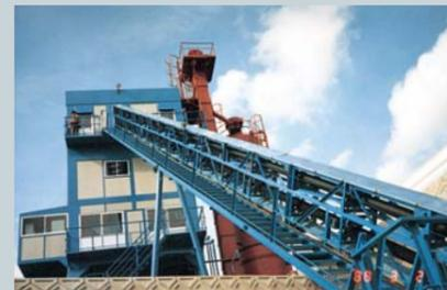
骨材の搬送ラインとして活躍するスーパーコンベヤ。ベルトが円筒形のため、搬送物との面圧摩擦抵抗が高く、フラットのコンベヤに比べて、傾斜角度を大きく取ることができます。また飛散、落粉も大幅に減少しています。
